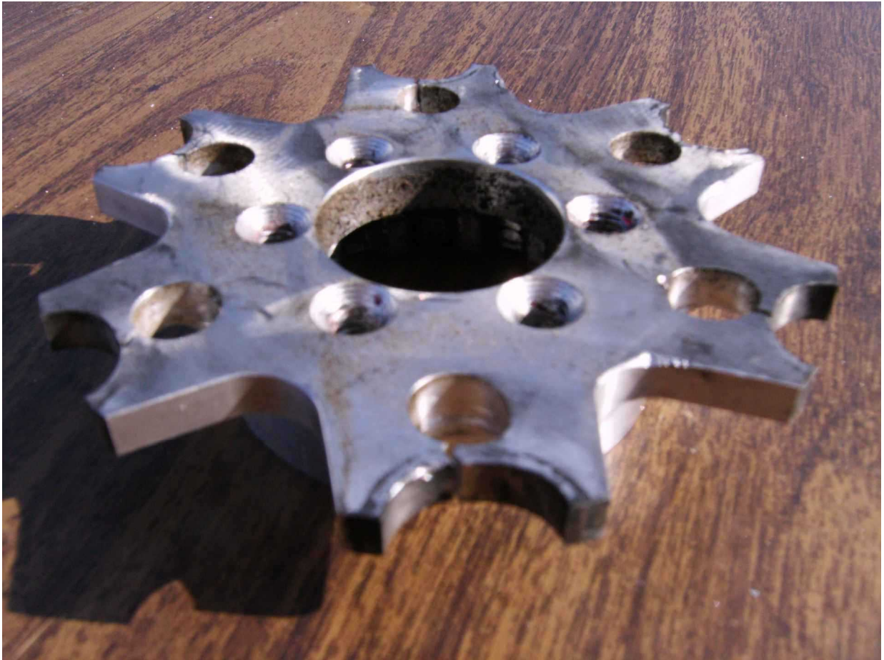
スプロケットハブ。スプロケットが取り付け小さな穴と大きな半円の間に亀裂が見られる
