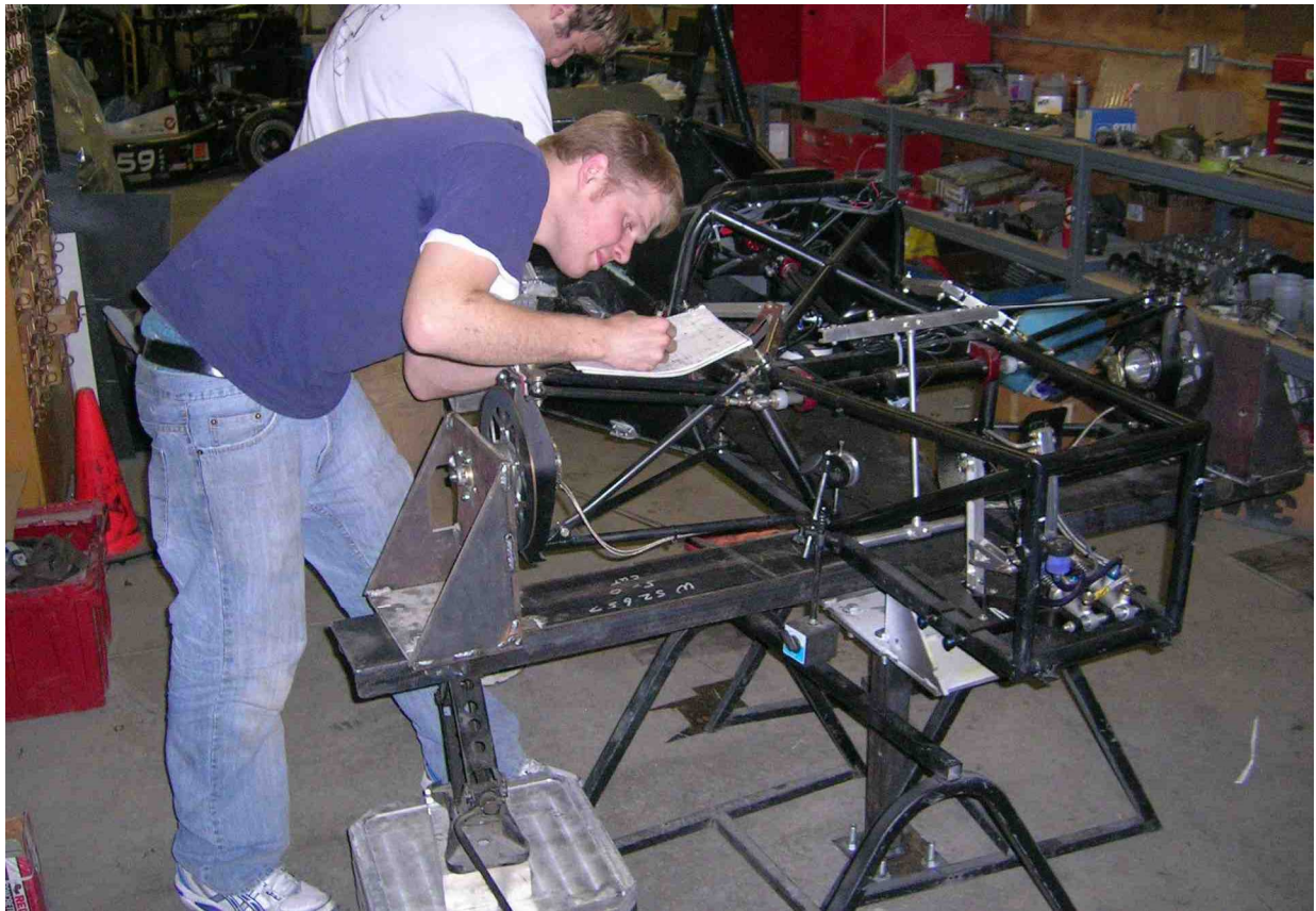
フレームのねじり剛性を測定するアンディ
